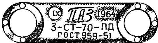
Рис. 3. Межаккумуляторная перемычка.
